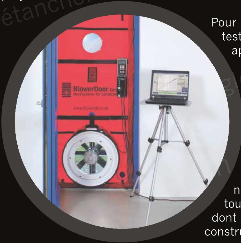
Pour cela, un professionnel réalisera un test d'infiltrométrie couramment appelé «test de la porte soufflante».
